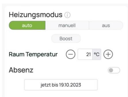
**Heizungsmodus:** Bei Abwesenheit kann die Heizung bequem ausgeschaltet werden. Zudem kann die Heizung manuell betrieben werden, womit mit der Trägheit der Gebäudemasse und dem Effekt der Solareinstrahlung experimentiert werden kann. Mit dem Boost-Modus kann das Gebäude während einer Stunde schnell aufgeheizt werden.
