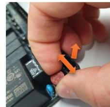
7. **Neue Sicherung einsetzen:** Setzen Sie die neue Sicherung an die gleiche Stelle ein.
