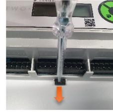
4. **Bodenplatte entfernen:** Lösen Sie die vier seitlichen Laschen und entfernen Sie die Bodenplatte der Steuerung.
